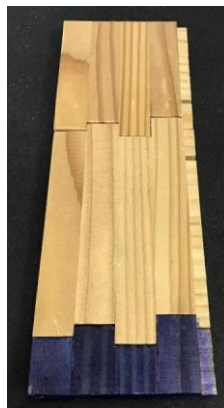
図4. 部分防腐処理の一例
