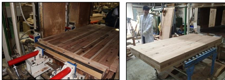
図2. 既存の平板プレスに四面サイドプレスを取り付けた簡易プレスの開発と1x2mの実大CLTの製造実験
