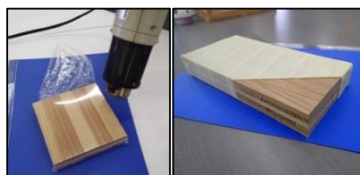
図3. ラッピングによる防水防腐技術 ※特許出願中「シート被覆木材」
