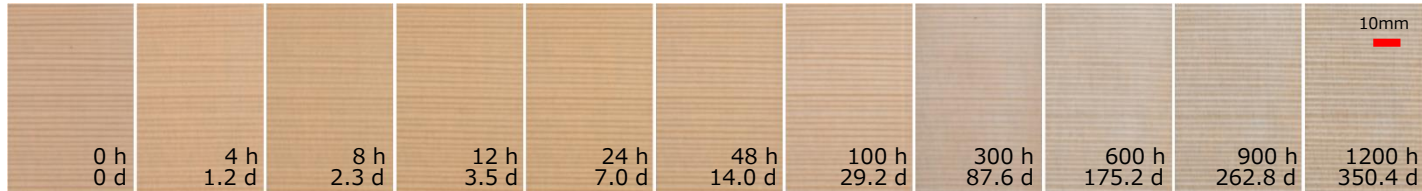
JIS K5600-7-7(キセノンランプ法)に準拠; 上段: 累積試験時間, 下段: 換算日数(促進倍率約7倍)
