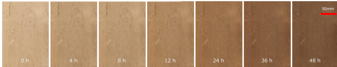
60℃で96時間の予備乾燥後, 空気雰囲気下170℃で処理; 数字は累積処理時間
