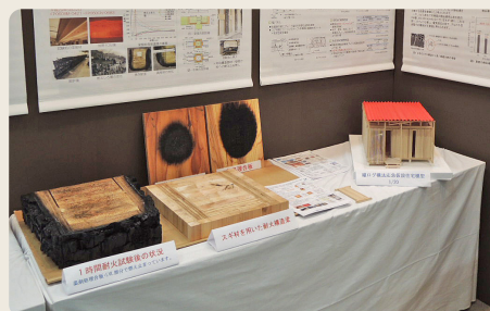
スギ材を用いた 耐火構造梁などの展示
